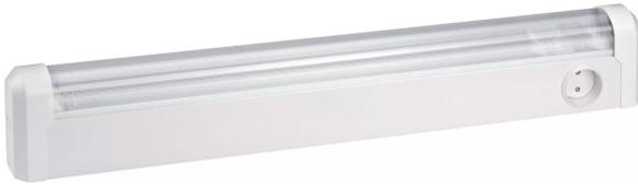
Réglette G13 18W (ballast électronique) IP44, autorisée Volume 2, avec PC 20VA, lampe non fournie
