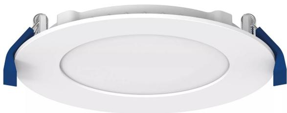
Downlight FLAT LED CCT faible épaisseur rond Ø110mm fixe blanc 110° LED intégrée 8W CCT (température de couleur réglable 2700K, 3000K ou 4000K) flux sortant 800 lumens en 4000K Alimentation LED séparée pré-câblée classe 2 IP20 fournie
