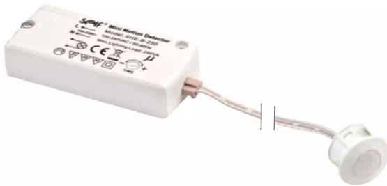
Micro-détecteur de passage infrarouge pour luminaire, à installer dans les plafonds et les cloisons. Utilisation intérieure uniquement. Installation horizontale ou verticale. Capteur déporté. Câble 1,5 m et connexion sans outil.
