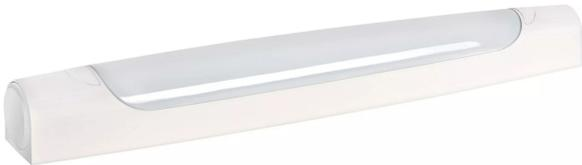
Réglette salle d'eau, corps asymétrique en polycarbonate blanc, IP44 IK07 autorisée volume 2, avec LED intégrées 6W 2700K, flux sortant 600 lumens. Durée de vie : 20000H.
