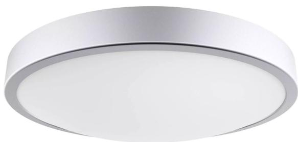
Plafonnier/Applique murale, Ø400mm, IP44 IK02, faisceau 110°, LED intégrée 21W, flux sortant 1500 lm 4000K. Variation Teinte (2700-6000K). Intensité lumineuse par télécommande (fournie). Vasque en PMMA opale, anneau décoratif amovible gris.
