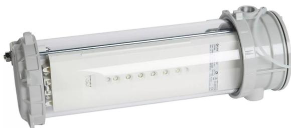
Bloc autonome d'éclairage de sécurité BAES d'évacuation tout LEDs antidéflagrant pour atmosphères explosives - IP66 IK07 Classe I - Super SATI - flux 45lm/1h et consommation 1W - livré avec pictogramme repositionnable
