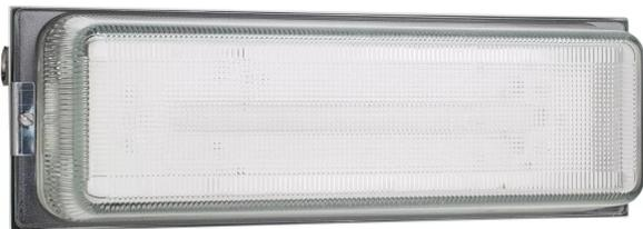
Bloc autonome d'éclairage de sécurité BAES d'ambiance tout LEDs type tôle et verre pour locaux à risques - IP66 IK04 Classe I - SATI/Adressable - flux 400lm/1h et consommation 1,1W
