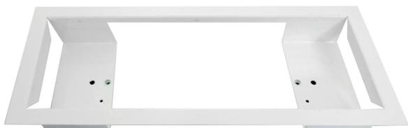
Cadre d'encastrement Boitier Zeta pour ULTRALED et PLANETE 400 étanche, Blanc. Encastrement total du bloc. Patte de serrage pour épaisseur de 0 à 40 mm. Réserve d'encastrement minimum 60 à 100 mm. Suspension de sécurité: compatible fixoplaf
