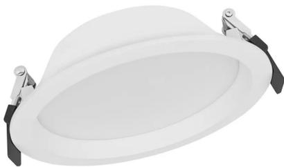
ledvance downlight led alu - avec batterie de secours 3h autotest - ip44 - 14w - 1260lm - 100° - 4000k - 50000h - classe ii - 160x52mm - diam découpe 150mm - alimentation externe fournie - enec - garantie 5 ans
