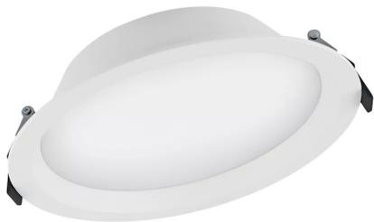
ledvance downlight led alu - avec batterie de secours 3h autotest - ip44 - 35w - 3150lm - 100° - 6500k - 50000h - classe ii - 215x61mm - diam découpe 200mm - alimentation externe fournie - enec - garantie 5 ans
