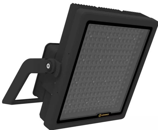
ledvance projecteur de forte puissance noir. optique asymétrique. 120lm/w, irc>70, 70 000h I70 à 25°C. température : -40°C...+50°C. poids 8,85kg. dimensions: 479x389x243mm. alimentation on/off ou dali à commander séparément. garantie 5 ans.
