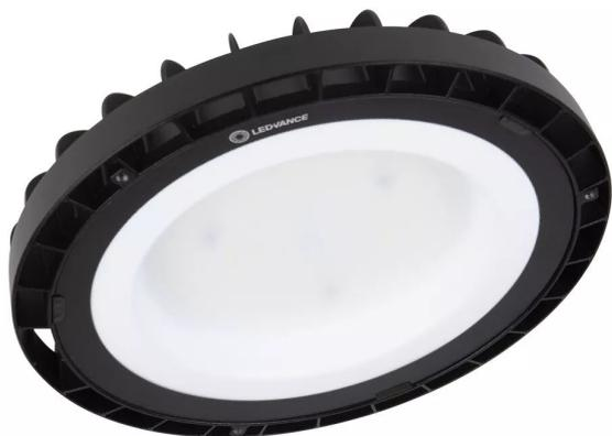
ledvance highbay led compact - class i - éclairage grande hauteur ip65/ik08 - 166w - 20000lm - 120lm/w - 120° - 6500k - 50000h l70 - classe i - précâblé (0,50m) - température de fonctionnement: -20°C...+50°C - garantie 3 ans
