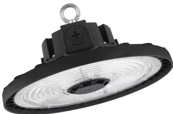
high bay de classe i en fonte d'aluminium noire. gradation via dali 2.0. performances remarquables : jusqu'à 176lm/w et 100 00h l80 à 35°C. irc80, sdc< 4. nombreux accessoires. dimensions : ø280 x 161 mm. enec. garantie 5 ans.
