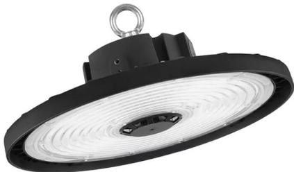
high bay de classe i en fonte d'aluminium noire. sélecteur de puissance 2 niveaux. performances remarquables : jusqu'à 181lm/w et 100kh l80 à 35°C. gradation 0-10v. irc80, sdc < 4. nombreux accessoires. ø321 x 162 mm. enec. garantie 5 ans.
