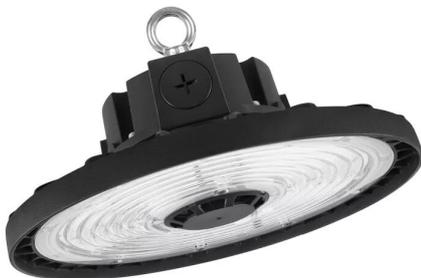
high bay de classe i en fonte d'aluminium noire. sélecteur de puissance 2 niveaux. performances remarquables : jusqu'à 178lm/w et 100kh l80 à 35°C. gradation 0-10v. irc80, sdc< 4. nombreux accessoires. ø280 x 161 mm. enec. garantie 5 ans.
