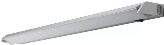
ledvance applique murale linéaire orientable en aluminium argenté. 10w, 620lm, 3000k, 30 000h I70, ip20/ik03. classe ii. dimensions (lxlxh) : 557x60x24mm. câble de 1,5m fourni. mise en ligne jusqu'à 10 luminaires possible. garantie 5 ans.
