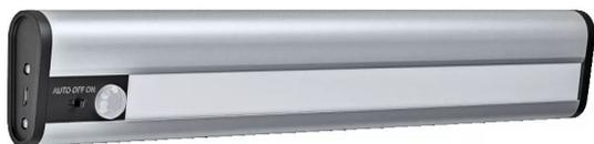
luminaire pour les dessous d'armoire pour montage flexible, avec détecteur de mouvement et de lumière intégré, alimenté par piles, rechargeable. boîtier : aluminium. 1,5w/4000k. commutateur pour mode auto. dimensions : 300x50x22mm (lxlxh)
