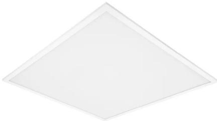
ledvance panel cmft, cadre alu blanc - 28w, 3640lm, 3000k, 130lm/w, 70 000h l80 - ip40, classe ii, 595x595x35mm - sélection flux par interrupteur, bornier auto, montage encastré, saillie, suspension (accessoires), filin - garantie 5 ans
