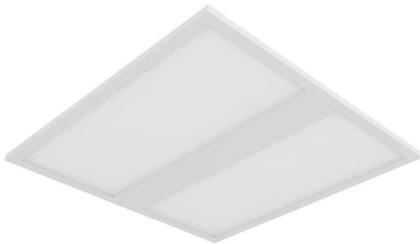
ledvance panel led 600 ip54 avec sélecteur de puissance 4 niveaux sur l'alim. classe ii, 120°, jusque 140lm/w, 70 000h I80 et 100 000h I70, sdc<sub>m</sub>3, test fil incan. 850°C. bornier auto avec repiquage et filin de sécurité inclus. garantie 5 ans
