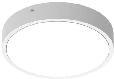
hublot led blanc de classe ii en polycarbonate résistant aux uv. sélecteur de puissance et de température de couleur. jusqu'à 132lm/w, 55000h l80. ip65/ik10. anneau de série, casquette en option. réparable. dim. : ø312x73mm. garantie 5 ans
