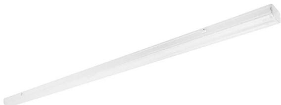
corps en acier laqué blanc, diffuseur en pc transparent, optique double symétrique (ds) 2x30°, jusque 175lm/w, 80000h l80, classe i, ip40/ik04. mise en ligne ou standalone. dimensions (lxlxh) : 1500x66,8x77,4mm, enec, garantie 5 ans
