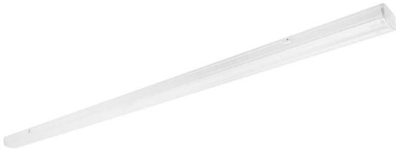
corps en acier laqué blanc, diffuseur en pc transparent, optique asymétrique (wall washer) 40°, jusque 175lm/w, 80000h l80, classe i, ip40/ik04. mise en ligne ou standalone. dimensions (lxlxh) : 1500x66,8x77,4mm, enec, garantie 5 ans
