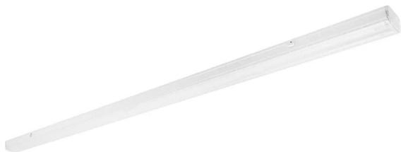
corps en acier laqué blanc, diffuseur en pc transparent, optique double symétrique (ds) 2x30°, jusque 175lm/w, 80000h l80, classe i, ip40/ik04. mise en ligne ou standalone. dimensions (lxlxh) : 1500x66,8x77,4mm, enec, garantie 5 ans
