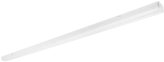
corps en acier laqué blanc, diffuseur en pc transparent, optique intensive (n) 60°, jusque 175lm/w, 80000h l80, classe i, ip40/ik04. mise en ligne ou standalone. dimensions (lxlxh) : 1500x66,8x77,4mm, enec, garantie 5 ans
