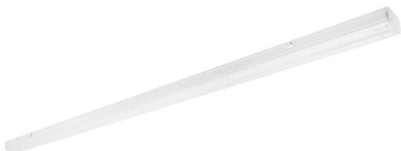
corps en acier laqué blanc, diffuseur en pc transparent, optique intensive (n) 60°, 175lm/w, 80000h l80, classe i, ip40/ik04. alim dali touch dim. mise en ligne ou standalone. dim (lxlxh) : 1500x66,8x77,4mm, enec, garantie 5 ans
