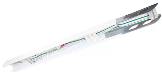
ledvance trusys flex led - classe i - dimensions (mm) : 750 x 70,2 x 38,8 (lxlxh) - rail d'alimentation 600 8x2,5mm<sup>2</sup> - pour sensor track (adaptateur avec détecteur de présence et de luminosité) - garantie 2 ans
