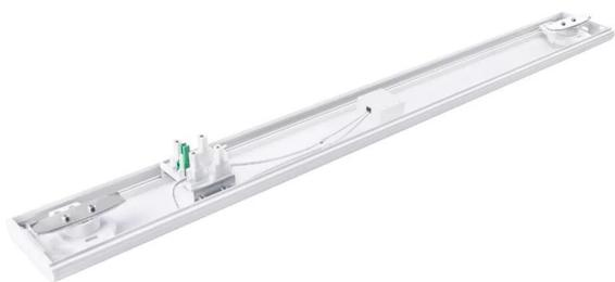
accessoire - cache en acier laqué blanc dans lequel est intégré un détecteur de présence et de luminosité. régulation selon l'apport de lumière naturel. pour rail 600 ou 600 end 8p. connecteur 8p 2,5mm<sup>2</sup>. dim (lxlxh) : 598,5x69,8x63mm
