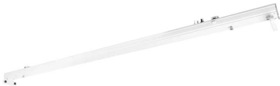
accessoire - réglette en acier blanc pour 2 tubes t5 1 500 mm (non fourni). classe i. s'intègre facilement aux rails d'alimentation on/off 5p. possibilité d'ajouter un réflecteur en option. dimensions : 1498,5 x 97 x 91,3mm. garantie 5 ans.
