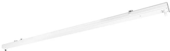
accessoire - réglette en acier blanc pour 1 tube t5 1 500 mm (non fourni). classe i. s'intègre facilement aux rails d'alimentation on/off 5p. possibilité d'ajouter un réflecteur en option. dimensions : 1498,5 x 77,7 x 91mm. garantie 5 ans.
