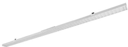
module led universel classe i, à encliqueter, pour une large gamme de rail d'alimentation. sélecteur de puissance (5 niveaux) et de phase. jusqu'à 180lm/w, 100kh l80, ip20, optique extensive 60°. dim. : 1504x68x26mm. enec. garantie 5 ans.
