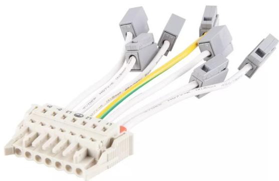
accessoire pour trusys universel. connecteur électrique 7 pôles pour raccorder les modules lumineux trusys universel dali au secteur. section de câble maximale : 1,5mm<sup>2</sup>. garantie 2 ans.
