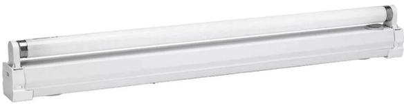
Ura - Régllette d'ambiance fluorescente 48Vdc à poser dans plastron - IP20 - Classe I - flux 1250lm et consommation 23W - à équiper du tube fluo référence 956315
